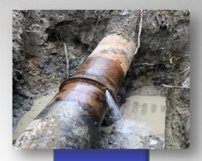
Gussrohr DN 900, Arbeitsdruck 14 Bar
