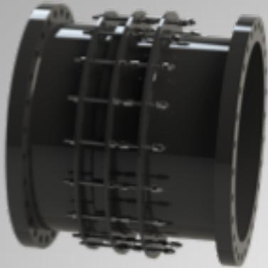
Das Pass- und Ausbaustück Typ JJ dient als lineares Ausgleichsstück und zugleich als Ausbaustück. Der große Verstellbereich von 100mm bietet eine hohe Flexibilität. Verfügbar ist diese Variante ab der Nennweite DN 300.
