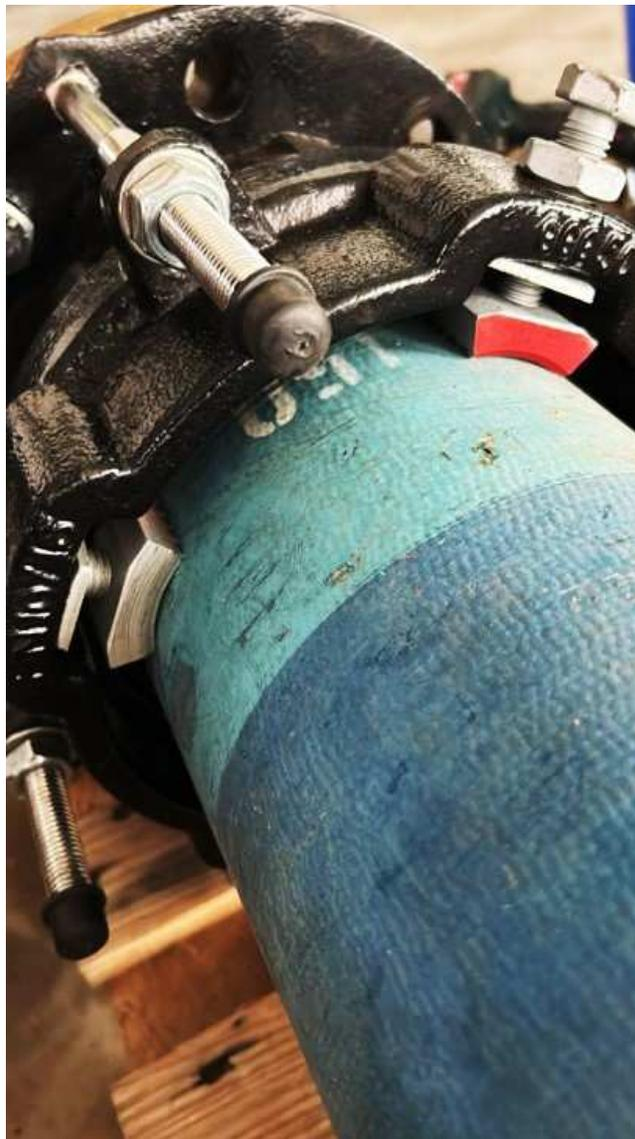
Die T-Grip Flanschadapter und Kupplungen sind mit einem unabhängigen Dicht- und Zugsicherungssystem ausgestattet. Die Greifelemente werden über zusätzliche Schrauben gegen das Rohr gepresst.
