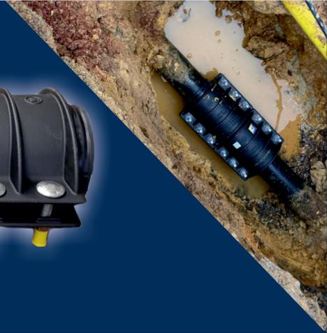
Unsere **innovativen verlängerbaren Dichtschellen** aus qualitativ hochwertigem duktilen Gusseisen können hintereinander montiert und mittels überlappender Dichteinsätze (Dichtwerkstoff EPDM) stirnseitig miteinander verbunden werden.
