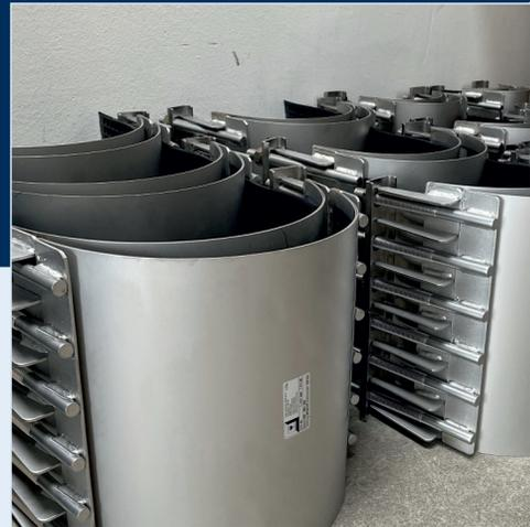
Einsatz unserer Thelen Edelstahl-Reparaturschelle in DN 100 für eine Leitung mit 18 bar Arbeitsdruck. Die EPDM-HT Dichtung ermöglicht Temperaturbeständigkeit bis 110°C.
