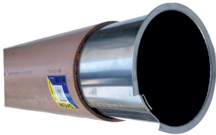
Edelstahl-Stützhülsen aus Werkstoff Nr. 1.4301 zur Innenabstützung bei mechanischen Rohrverbindungen mit Kupplungen oder Steckmuffe.
