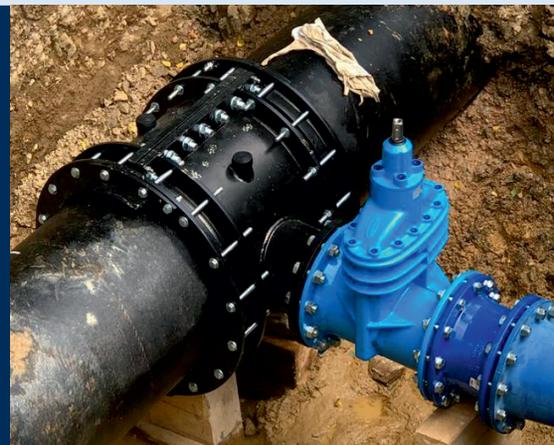
Geteilter Überschieber aus Stahl mit Rilsan-Beschichtung **Typ T-Fit 10** ab der Nennweite DN 300 und für Druckstufen bis PN 40 für Wasser und Abwasser
