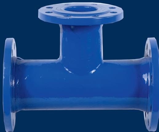
Flansch- und Muffenformstücke aus duktilem Gusseisen in den Ausführungen PN 10 und PN 16 mit EKB-Beschichtung nach GSK-Richtlinie liefern wir in den Nennweiten **DN 50 - DN 1200**.
