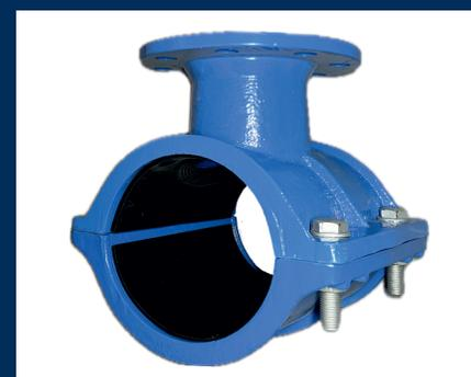
Geteilter Überschieber **Typ GU2 KS** aus Guss ab der Nennweite DN 80 und für Druckstufen bis PN 16 für Wasser und Abwasser, speziell für PE- und PVC-Rohre
